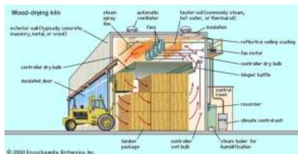
Slika 4: Konvencionalna komorska sušilnica
